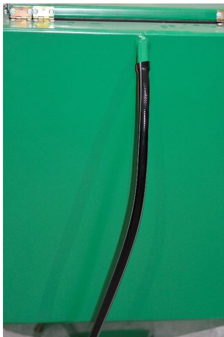
Rys. Króciec w zbiorniku wraz z poprawnie zamontowanym węzłem
